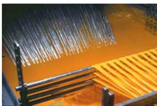
Le fibre sono guidate nel bagno di resina. Anche qui le fibre rimangono guidate ed in tensione per consentire alla resina di bagnare ogni fibra.
