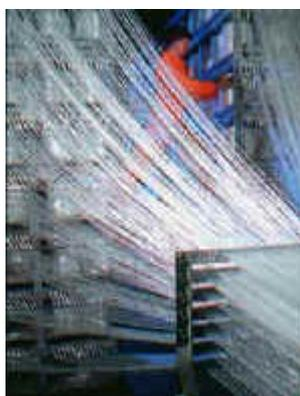
Nella prima stazione, la fibra è ottenuta da un sistema che tira i pacchetti (o matasse) che stanno sulle rastrelliere. La fibra è guidata attraverso occhielli in porcellana che eliminano l'accumulazione elettrostatica e la degradazione del vetro, (fuzzing). La fibra viene orientata prima dell'ingresso nel bagno della resina.
